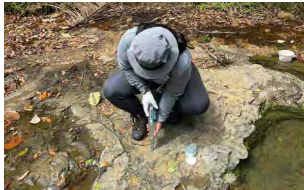
Ensayo de esclerómetro en roca para determinar su dureza, realizado en la localidad de Galique, distrito de San Félix, provincia de Chiriquí
