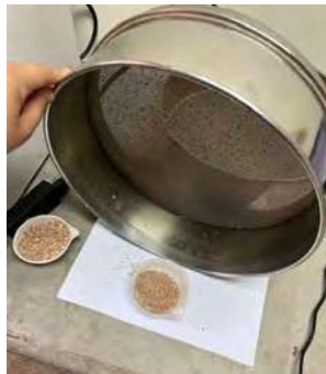
Análisis de muestras de suelo mediante el ensayo de granulometría, aplicado para la clasificación completa del material conforme a norma ASTM D422
